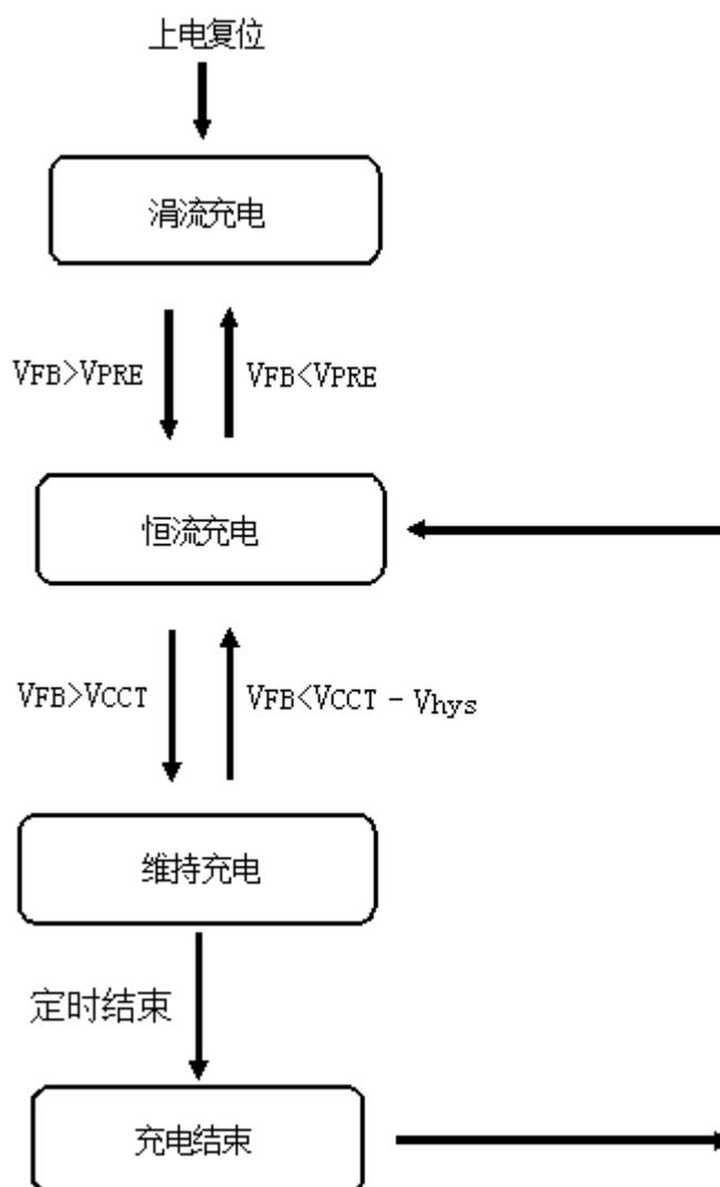
图4 充电流程图
