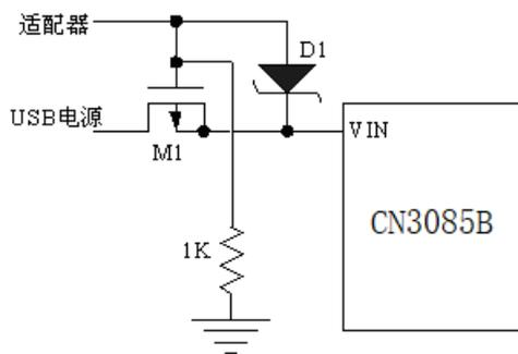
图6 同时使用墙上适配器和USB接口
