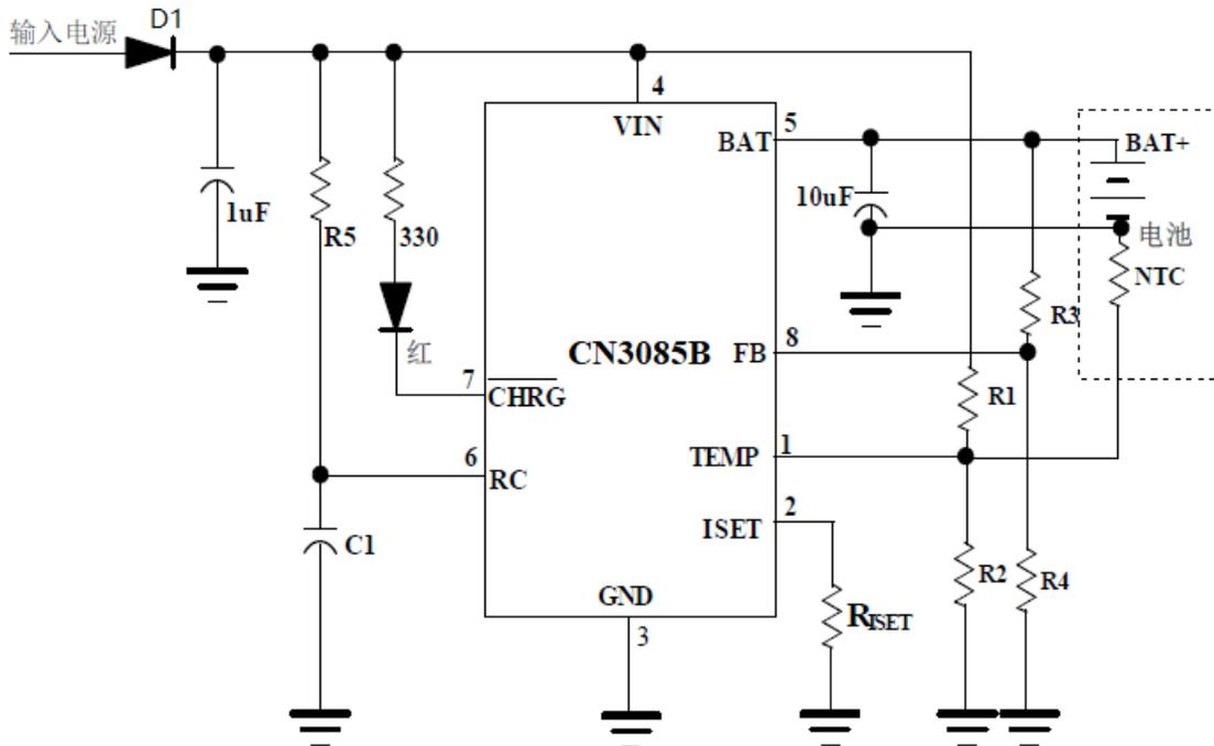
图7 增加二极管抑制过冲电压
