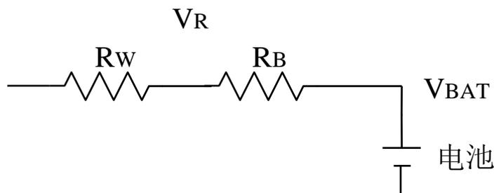
图 5 电池内阻和导线寄生电阻示意图
